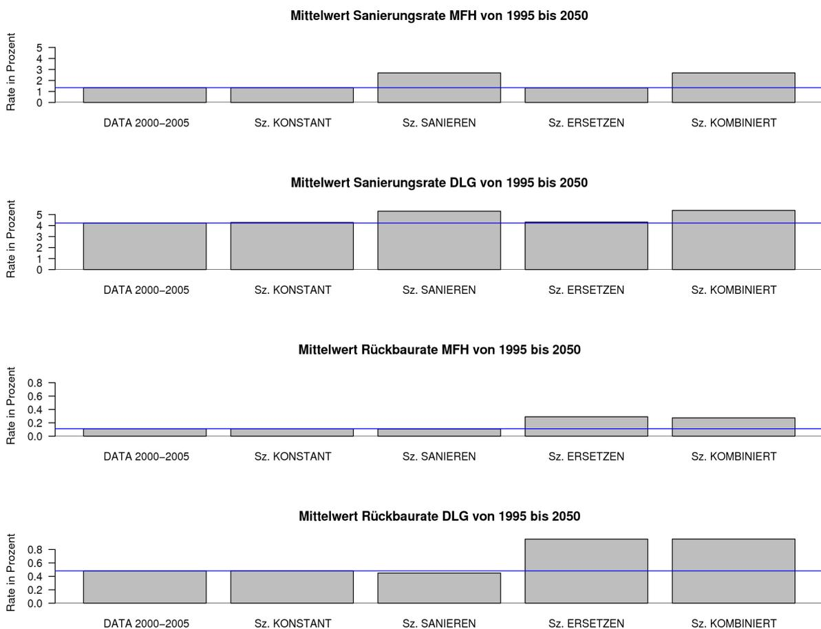
Figur 18 Die gewählten Raten für Sanierungen (oben) und Rückbauten (unten) am Beispiel der MFH und der DLG. Die Spalte ganz links zeigt die bekannten Daten der Jahre 2000–2005. Die blaue horizontale Linie verläuft auf der Höhe dieser Werte. Die weiteren Spalten zeigen von links nach rechts die Modellresultate (Mittelwerte) für die Szenarien KONSTANT, SANIEREN (Sanierungsrate erhöht), ERSETZEN (Rückbaurrate erhöht) und KOMBINIERT (Sanierungs- und Rückbaurrate erhöht).
